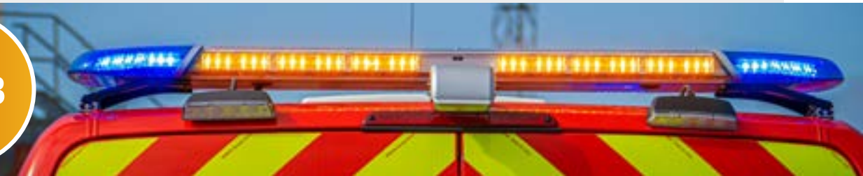
Absicherung nach hinten mit Heckwarnsystem
