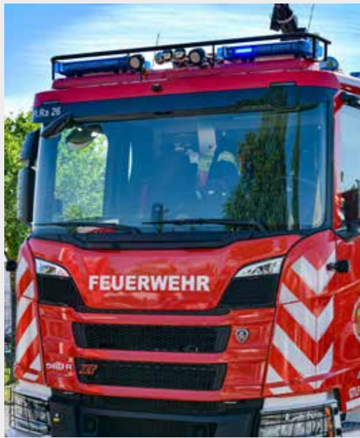
Der DBS 850 in geteilter Ausführung (650mm) mit zwei Paaren „Zusatzblitz blau“ und einem Paar „Powerblitz“.
