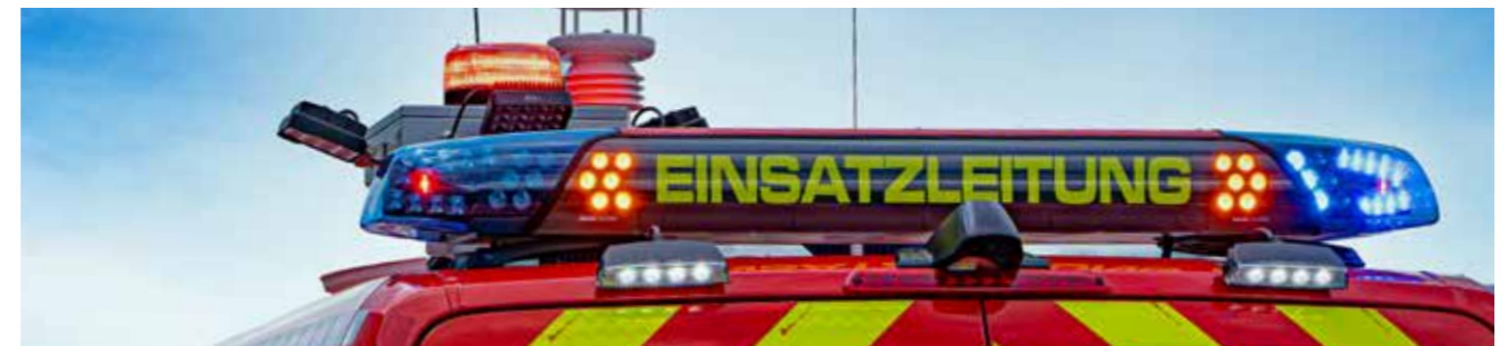
Eine ideale Kombination: Ein ELW mit der optionalen rundum sichtbaren Kennzeichnung „Einsatzleitung rot“ im Heckbalken (DBS 4000) und eine zusätzliche COMET S in Rot mit klarer Haube auf dem pneumatisch ausfahrbaren Lichtmast für eine gute Erkennbarkeit auch aus größerer Entfernung.
