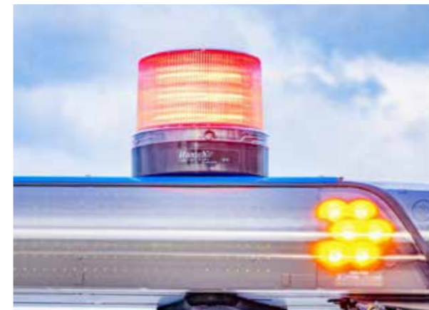
COMET LED in Grün/Rot unter klarer Haube auf einem DBS 4000.
