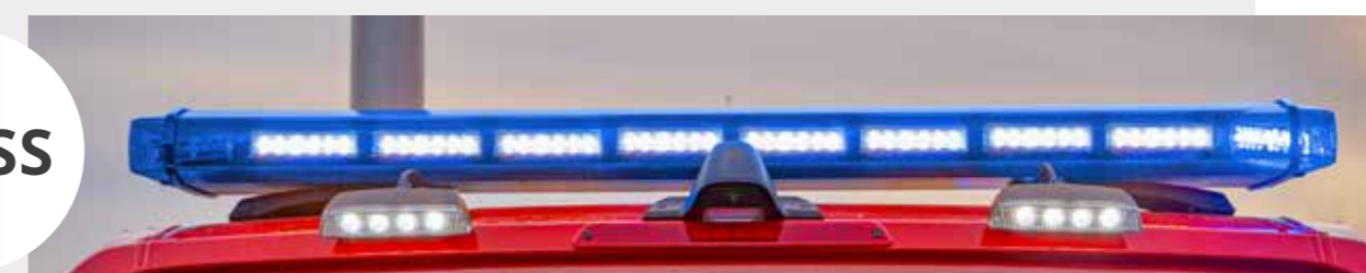
Arbeitscheinwerfer zur Ausleuchtung des Einsatzortes
