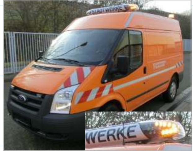
das blaue Warnsignal geführt. Am Einsatzort kann die Kennleuchte auf gelb umgeschaltet werden und somit als Warnsignal zur Absicherung dienen.
