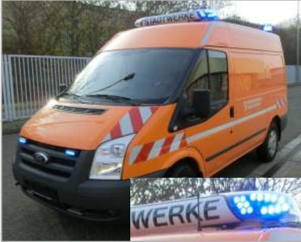
Das zwei-farbige Balkensystem DBS 4000 LED ist von blau auf gelb umschaltbar. Beide Farben haben die Zulassung nach ECE-R 65. Als Kennzeichnung des Wegerechtes wird auf der Fahrt zum Einsatzort
